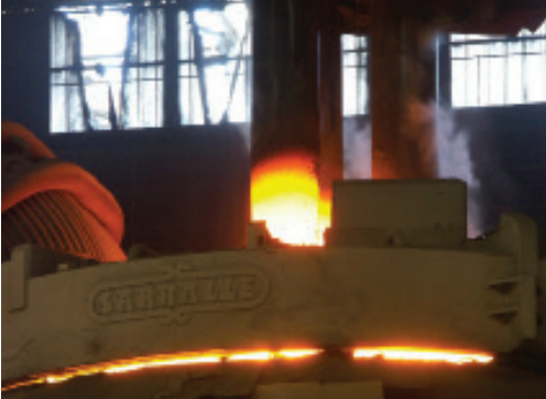
Horno eléctrico de arco (capacidad: 90 ton) ▼
