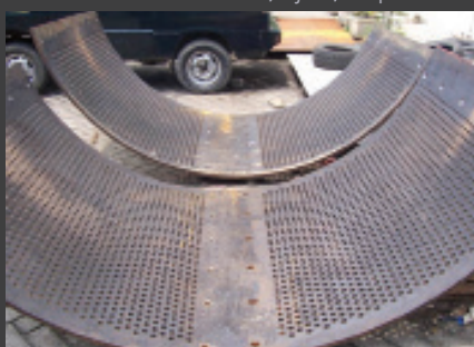
Piso de cribado, rejillas, romperocas ▼
